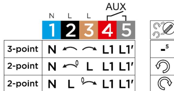
4.11. Электроподключение аналогового привода осуществляется в соответствии со схемой:
